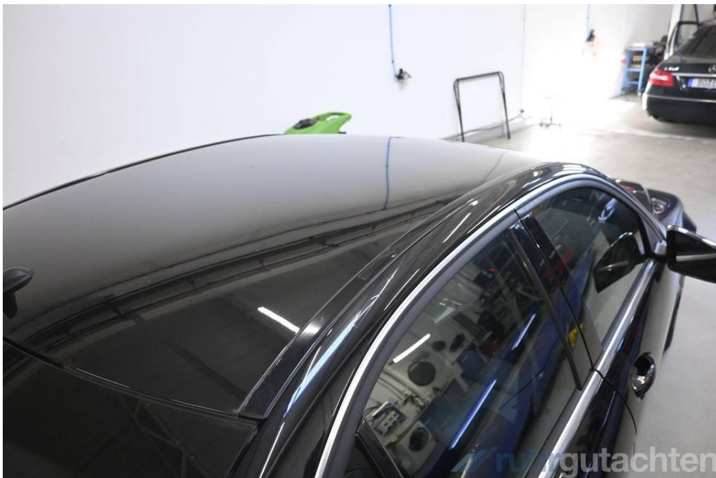
Nicht reparierter Vorschaden: Dachleiste rechts Abdeckung gebrochen
