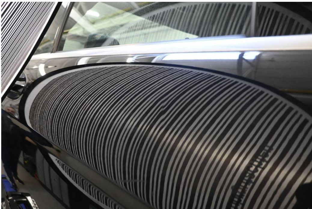
Nicht reparierter Vorschaden: Tür hinten rechts eingedellt
