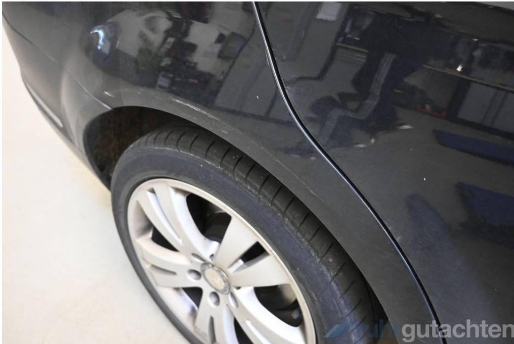
Seitenwand hinten rechts kratzbeschädigt
