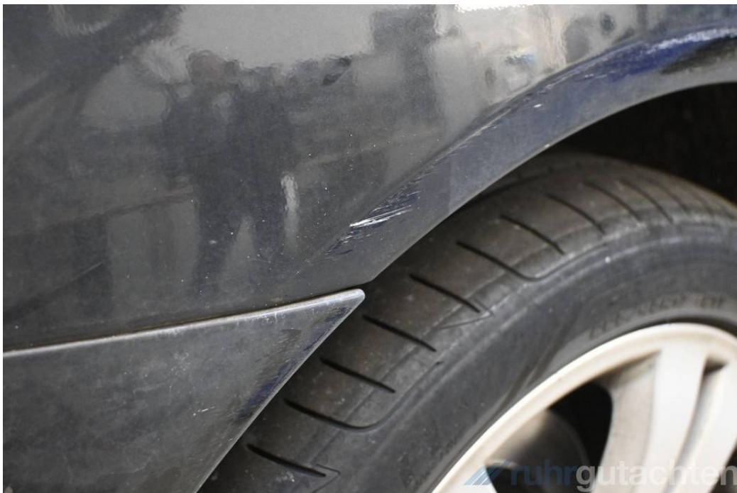
Seitenwand hinten rechts kratzbeschädigt
