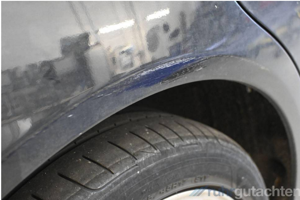
Seitenwand hinten rechts kratzbeschädigt
